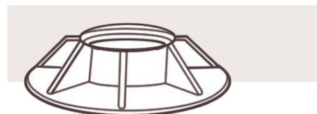
BI\_Base Rosca Interna (base para aplicação direta sobre lajes com regulagem). 100% polipropileno injetado.
