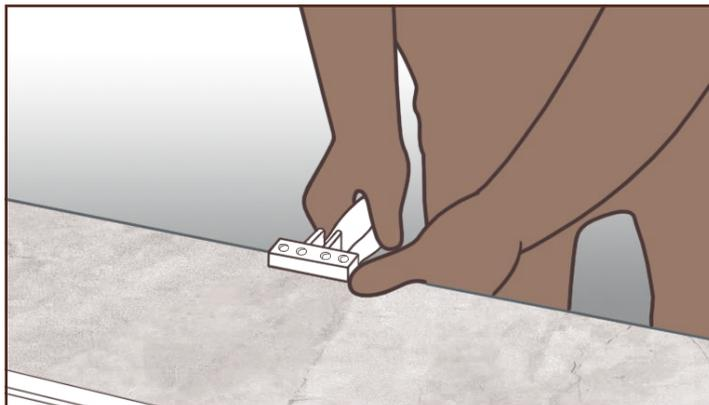
4\_ Concluir o processo de abertura com os alicates e, novamente, exercer pressão progressiva para baixo ao longo de toda a linha da ranhura na placa.
